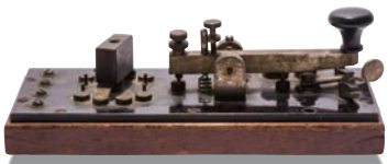
陸軍通信隊の電鍵 通信兵がモールス信号を打つための機器です。昭和16年製造。この電鍵は、陸軍の通信隊に配属となった初年兵の訓練で使用されました。
